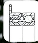
Cojinete de bolas de contacto angular de doble hilera con bridas con alojamiento fenólico. Capaces de soportar la carga axial en cualquier dirección, además de la carga radial. Tolerancia/precarga según requerimientos.
