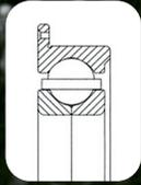
Cojinete doble de bolas con bridas, apto para soportar la carga axial en cualquier dirección. Tolerancia/precarga axial según los requerimientos del cliente.
