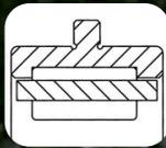
Cojinete de bolas con brida en medio del diámetro de la cara exterior, con ranura de ubicación y alojamiento de bronce de una sola pieza.
