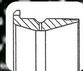
Copa con doble brida para acomodar dos conos de bolas cónicas, con ranura de lubricación y agujeros de lubricación.
